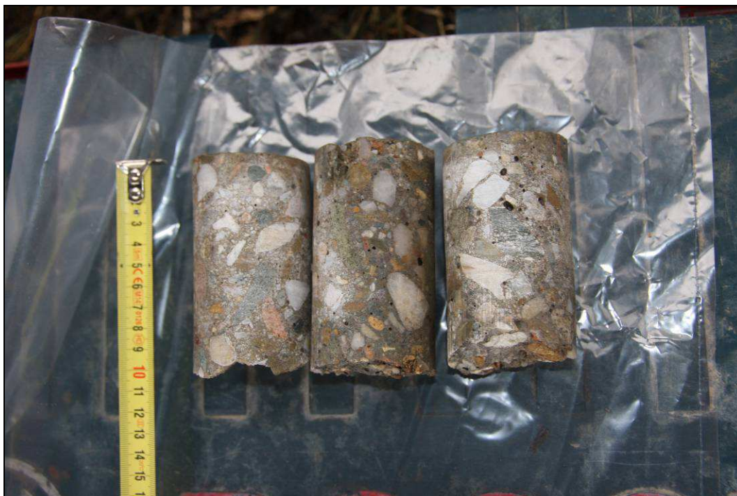
Obr. č. 1 - návrty - nosná konstrukce nad opěrou Nový Malín
